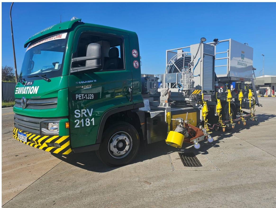
Unidade de Abastecimento de Aeronaves 100% elétrica da BR Aviation no Aeroporto de Guarulhos Crédito: Divulgação
